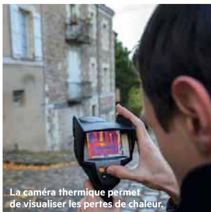
La caméra thermique permet de visualiser les pertes de chaleur.
